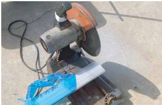
コーナー材本体はアルミ製なので切断機で簡単に寸法カットが行なえます。
