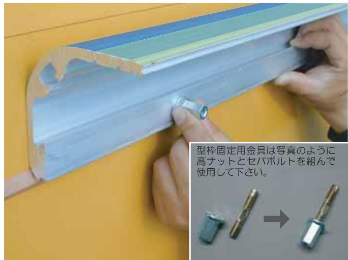
型枠固定用金具をセットし、固定用穴に差込み表側から型枠用ホームタイで固定します。
